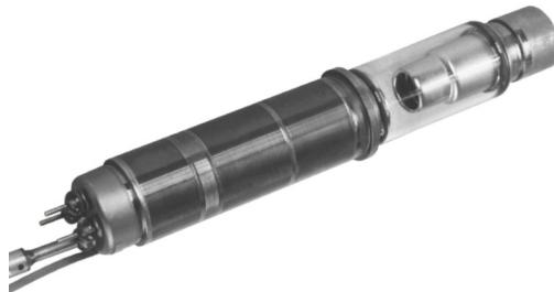
Рис. 4.3. Нейтронная трубка. Длина - 190 мм, диаметр - 30 мм, вес - 220 г. Ускоряющее напряжение - 80 кВ. Поток нейтронов -  $1 \cdot 10^8 n/(с \cdot см^2)$
